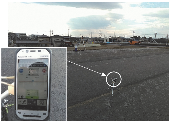
写真7 自動追尾式TSによる出来形管理
