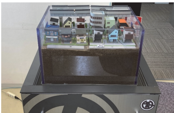
写真 1 1 液状化実験装置
