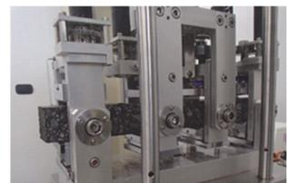
図-1 想定される施工パターンを模擬したひび割れ抵抗性の評価
