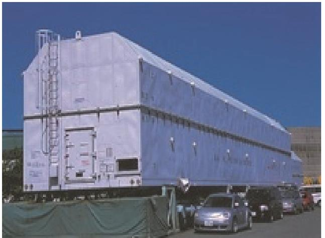
写真2 ロケット積み出し専用コンテナ
