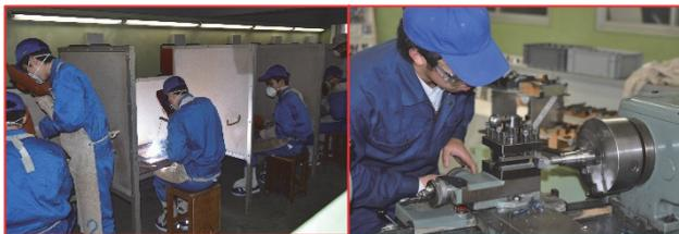
【アーク溶接と旋盤による金属加工実習（メカトロニクス系列）】
